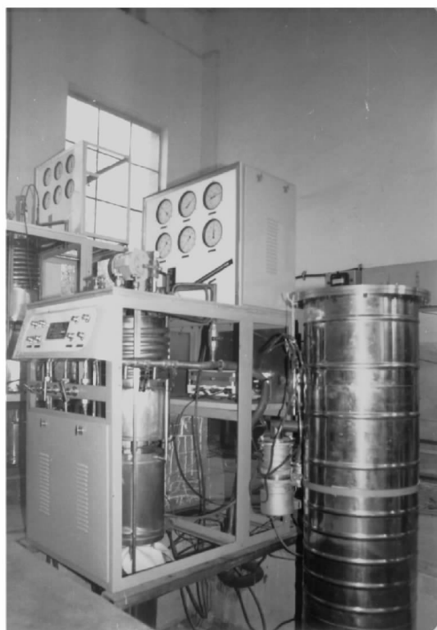
自制氢液化器照片 右侧为液化器的杜瓦容器
